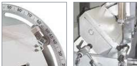
Tronçonneuse double tête avec une unité fixe à gauche et l'autre mobile. Double mitre saw with a fixed unit on the left and the other one movable.
