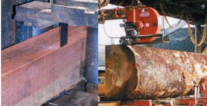
Une scie-ruban polyvalente. Les lames APEX MP offrent une valeur élevée dans une variété d'applications pour la coupe de bois. Les lames sont fabriquées à partir d'une seule pièce d'acier à haute teneur en carbone avec des pointes de dent trempées individuellement et en crochet.
