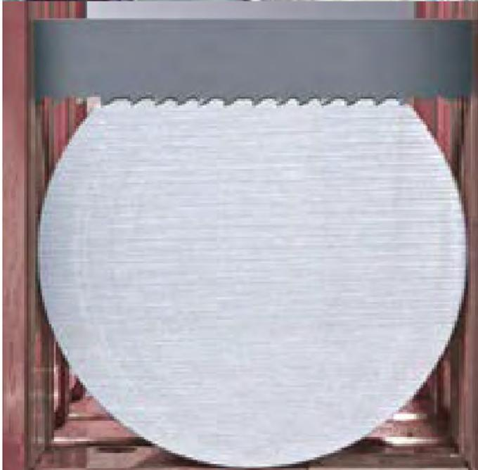
Lame de scie à ruban haute performance avec une géométrie de dent unique et un angle de coupe positif, spécialement conçue pour le sciage de matériaux difficiles à usiner ainsi que des aciers résistants à la rouille et aux acides. Excellente évacuation des copeaux.
