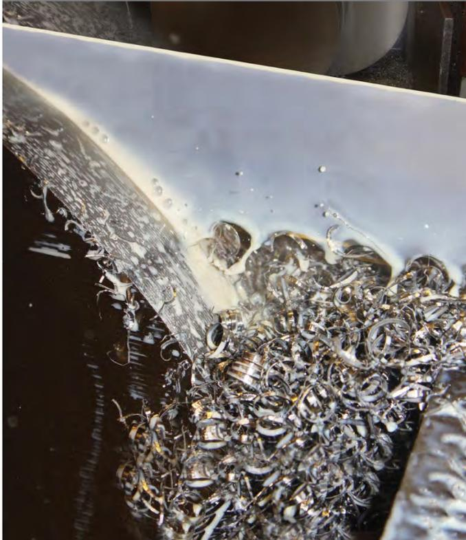
Une lame avec des dents en carbure à attaque négative (Negative Rake) qui fournit plus de résistance pour la coupe de matériaux trempés jusqu'à 65 Rc. Lame de scie à ruban idéale pour des coupes efficaces des arbres en chrome (« shaft » chromé ou à induction) et des matériaux trempés ou durcis.
