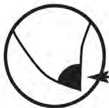
Pointe de dent en carbure soudée : 92 HRc
