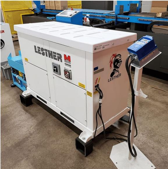
La LESTHER 4616 est une machine de finition vibratoire compact. Cette machine de finition et d'ébavurage robuste est efficace sur une grande variété de pièces. Cette machine silencieuse est facile à utiliser, économique et possède un couvercle atténuateur de son. Images illustrées comportant des accessoires optionnels.
