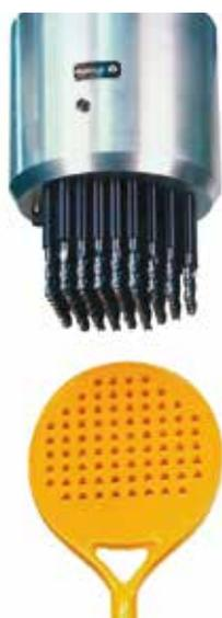
Application de perçage simultané de 76 trous sur raquette de paddle.
