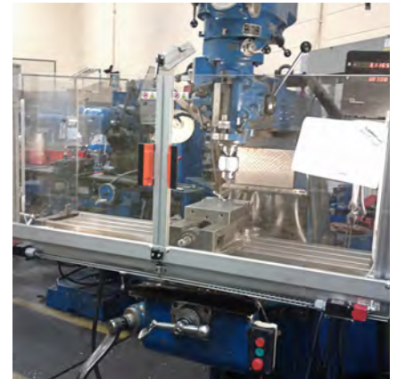
SÉCURISATION D'UNE FRAISEUSE MILLING MACHINE SAFEGUARDING
