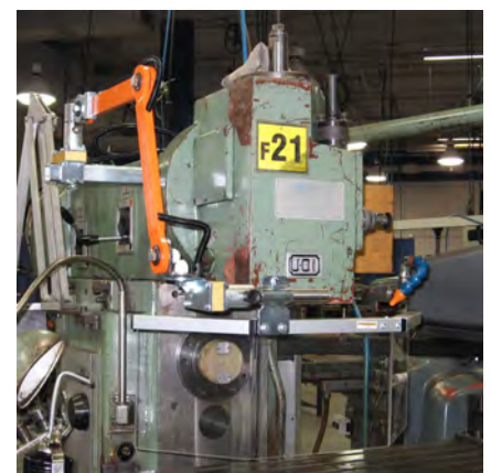
SÉCURISATION D'UNE FRAISEUSE MILLING MACHINE SAFEGUARDING
