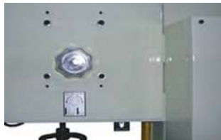
Alimentation du ruban sur le volant supérieur - Indicateur de tension du ruban Upper wheel tilt adjuster - Blade tension indicator
