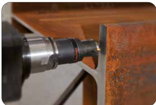
Tête de perçage rotative pour le fraisage des extrémités
