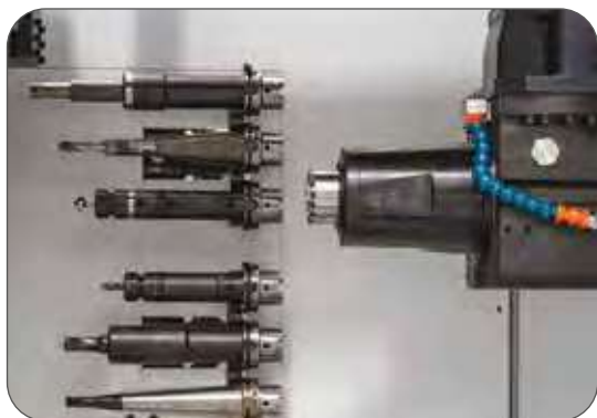
Changeur automatique d'outils à 9 positions
