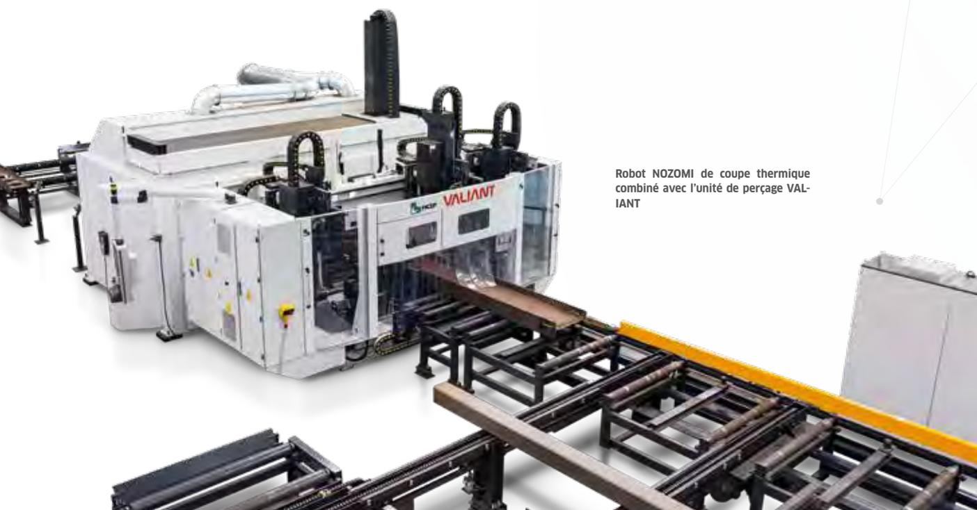
Robot NOZOMI de coupe thermique combiné avec l'unité de perçage VALIANT
