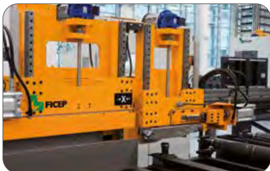
Deuxième bras de positionnement pour réduire l'encombrement
