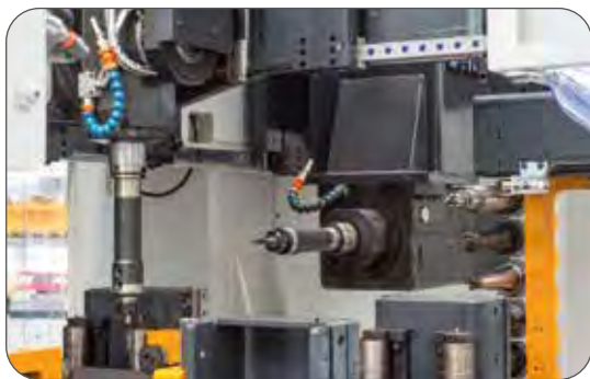
Deuxième tête de perçage avec changeur d'outils
