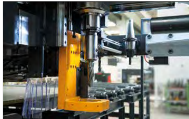
Tête de perçage (en option) avec changeur automatique d'outils à 4 positions
