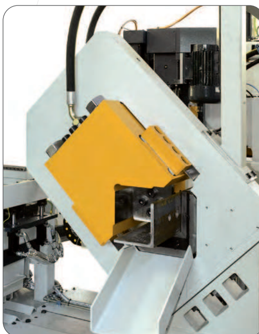
Cisaille en option pour le traitement des cornières jusqu'à 200x200x16 mm. Les deux cisailles sont positionnées sur des guides linéaires et sont automatiquement sélectionnées par le programme CNC.
