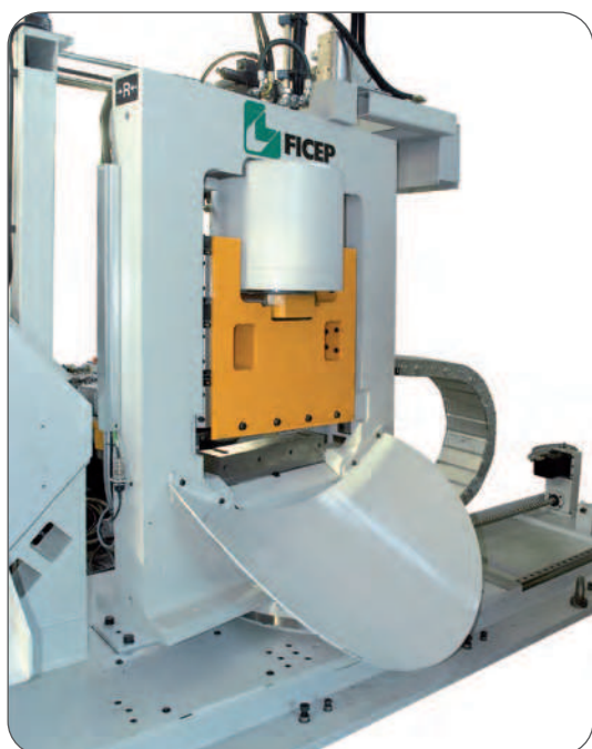
Rotation de la cisaille programmable contrôlée par CNC de +/- 45°. En option, il est possible d'obtenir des coupes en onglet de +/- 60°.
