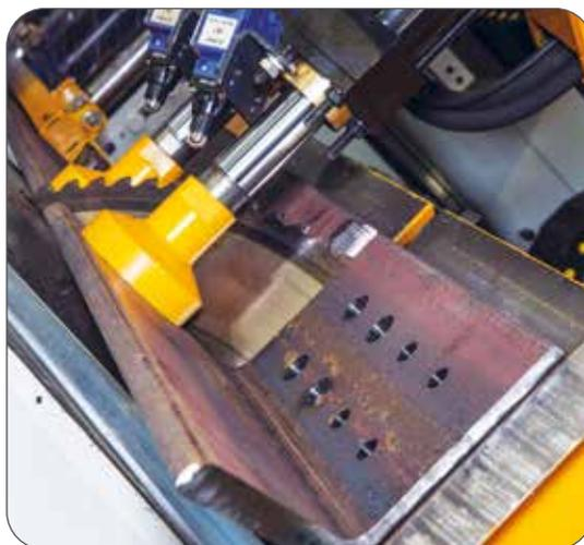
La TIPO D 50-F comprend une scie circulaire avec des inserts en carbure pour une productivité maximale. La scie peut se positionner automatiquement pour des coupes biaisées allant jusqu'à +/- 60 °.
