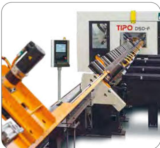
Le positionnement et la mesure du profilé sur la TIPO D 50-F sont réalisés avec un système de pignon / crémaillère. Une fois le serrage confirmé, la longueur du profilé est automatiquement mesurée avant le début du processus de fabrication.
