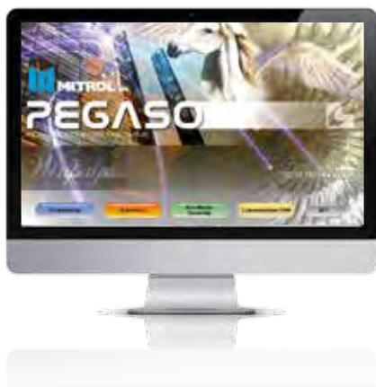
Pegaso est la dernière génération de CNC pour les lignes FICEP, où PC, CNC et PLC sont tous intégrés dans une seule carte mère pour une fiabilité maximale. Pegaso est basé sur une technologie de bus de terrain utilisant CanBus et EtherCAT pour contrôler jusqu'à 32 axes CNC distincts.
