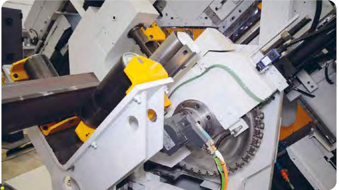
Il est possible de réaliser sur les cornières et les tubes des doubles coupes aux deux extrémités pour générer des structures typiques de charpente. La polyvalence du traitement des plats jusqu'à 500 mm sur 25 mm est démontrée par sa capacité non seulement à couper la pièce à la longueur, mais également à couper les coins selon les besoins.
