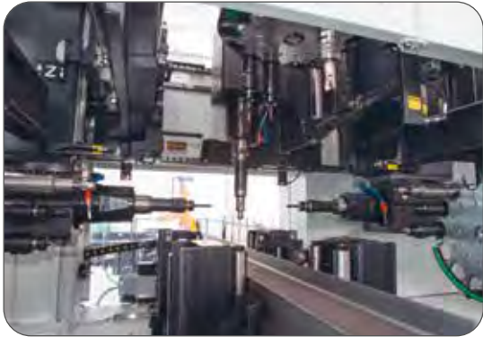
Changeur d'outils à 14 positions par broche
