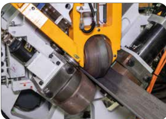
Système de transfert des cornières à rouleau
