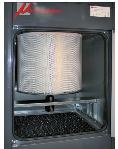
CELLULOSE FILTER CARTRIDGE HAVING BIG FILTERING SURFACE CARTOUCHE FILTRANTE EN CELLULOSE AVEC UNE TRÈS GRANDE SURFACE FILTRANTE
